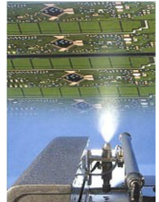
“ein Sprühbild mit 50%er Überlappung und dem gleichmäßigsten Flussmittelauftrag...”
