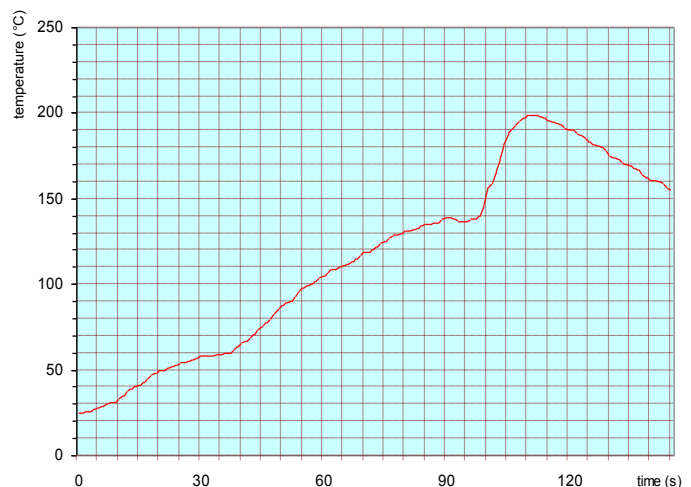
T° gemessen an der Oberseite der LP auf einer bleifreien Wellenlötmaschine
